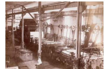
Papiermaschine, angetrieben über die Wasserkraft durch eine Transmission.
